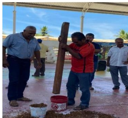
Figura 7. Apisonado de la mezcla para compactar el bloque.
