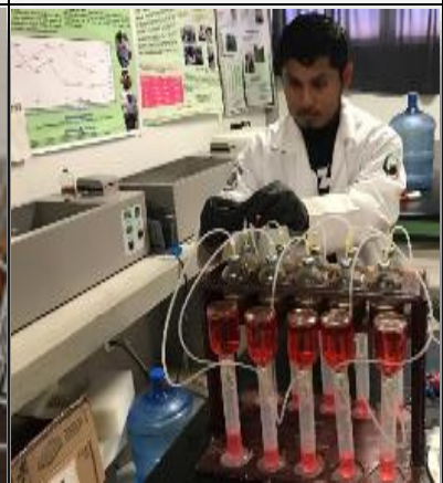
Figura 13. Medición de la producción de biogás y metano.
