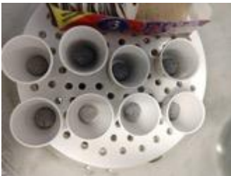
Figura 43. Determinación de materia seca.
