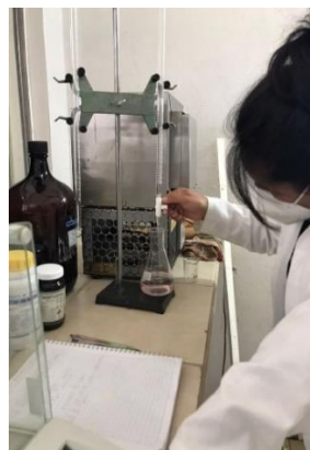
Figura 36. Titulación de muestras para determinar proteína cruda (PC).
