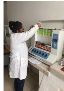
Figura 34. Extracción de fibras.
