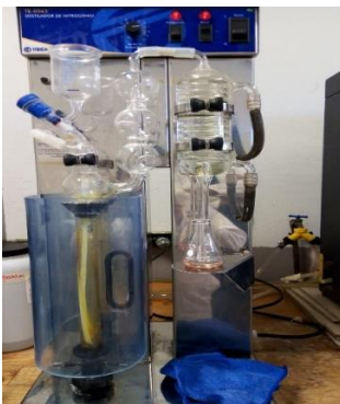
Figura 26. Digestión de muestras para determinar proteína cruda (PC).
