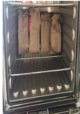
Figura 33. Secado de muestras a 55°C.
