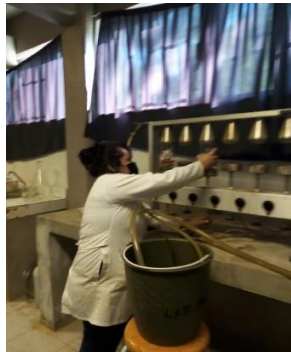
Figura 24. Proceso hervido y de enjuague de muestras para determinar FDA y FDN.
