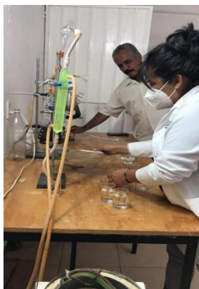
Figura 35. Destilación de muestras para determinar Proteína cruda (PC).
