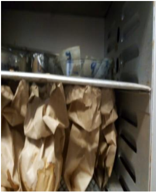
Figura 20. Secado de muestras a 55 °C en una estufa (Riossa® HCF-41, México).
