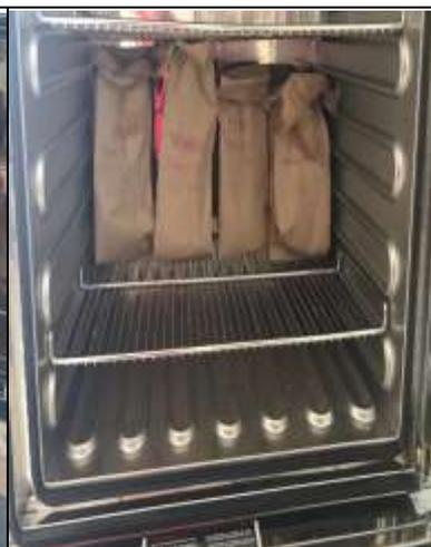
Figura 23. Secado de muestras a 55 °C para determinar composición morfológica.
